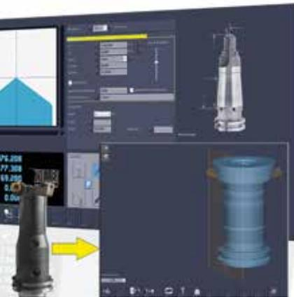
»3D-Scan« scannt Werkzeugkonturen unkompliziert und speichert sie in 3D-Formaten.
