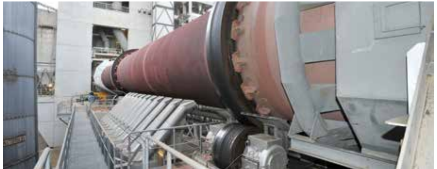
Innovatives Beispiel in der Zementproduktion ist die Errichtung eines Thermoölnetzes zur Brennstoffvorwärmung. Damit kann eine jährliche Einsparung an fossilen Energieträgern von 200.000 m 3 Erdgas erzielt werden (Wärmetauscher und Drehrohrföfen Zementwerk Leube).
