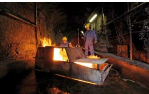
Im Maßstab 1:10 testet Siemens im Versuchsstollen Hagerbach Brandmeldeanlagen und Löschsyste- me.
