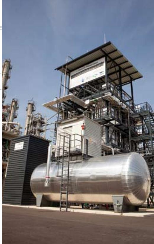
Neue Technologie entwickelt: Anlage wandelt Hackschnitzel direkt in Dieseldieselkraftstoff um.
