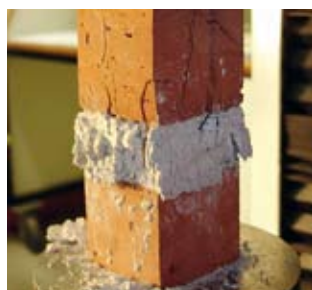
Anhand zahlreicher Materialtests – hier ein Druckversuch – entwickelten die Bauingenieure Materialkennzahlen.
