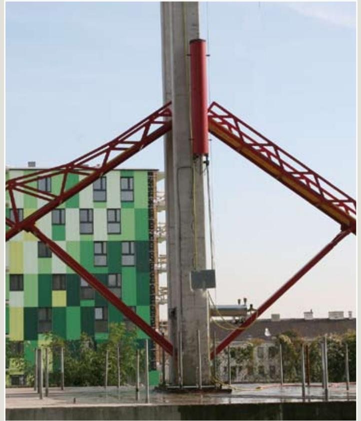
Die Klappbrücke beim Testlauf auf dem Versuchsgelände der TU Wien.
