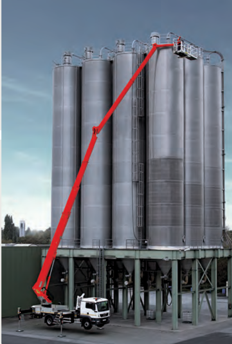
↑ Palfinger präsentiert die P 480 Hubarbeitsbühne mit einer Arbeitshöhe von bis zu 38 Metern.
