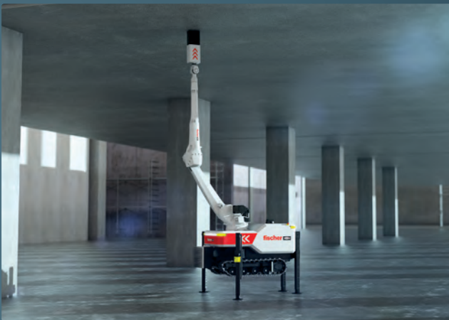
BauBot übernimmt die Bohrlocherstellung präzise an im Bauplan vorgegebenen Stellen und wird in Kürze fischer Befestigungslösungen installieren. Sind keine digitalen Daten der Baustelle vorhanden, lässt sich ein 3D-Scan durchführen.
