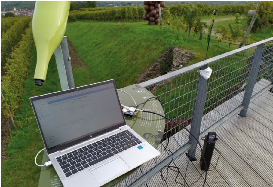
Über Gateways gelangen Daten von lokalen Sensoren auch über größere Entfernungen zu einem Server – etwa zur Temperaturüberwachung auf Weinbauflächen.
