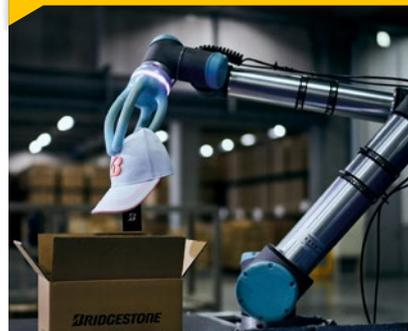
Soft-Roboterhände bei der automatischen Stückgutaufnahme.
