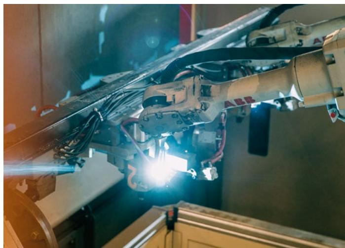
Multi-move-Roboterzellen werden bei der Fließfertigung von Off-road-Rahmen eingesetzt. Pro Schicht können damit pro Modell 75 Stück statt bisher 20 Stück produziert werden.
