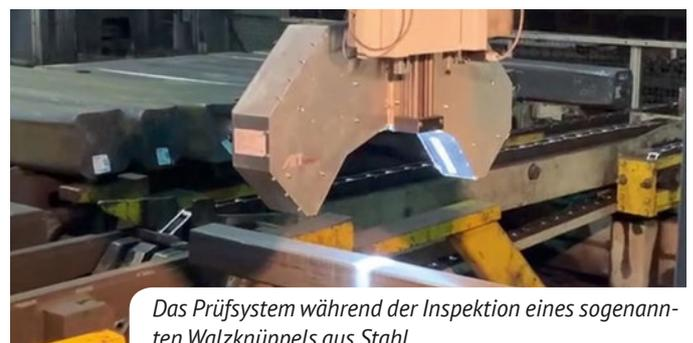
Das Prüfsystem während der Inspektion eines sogenannten Walzknüppels aus Stahl.
