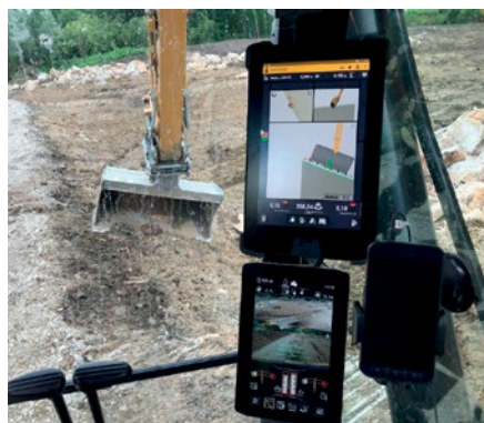
Ob Kanalwesen, Straßenbau oder Tunnel – GPS-Baumaschinensteuerungssysteme erhöhen Effizienz und Sicherheit auf der Baustelle (im Bild: Steuerbox GPS-Bagger).
