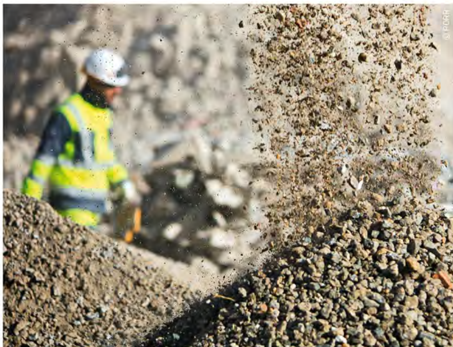
Beton wird zerkleinert und im Recycling Center Himberg zu Recyclingbeton verarbeitet.
