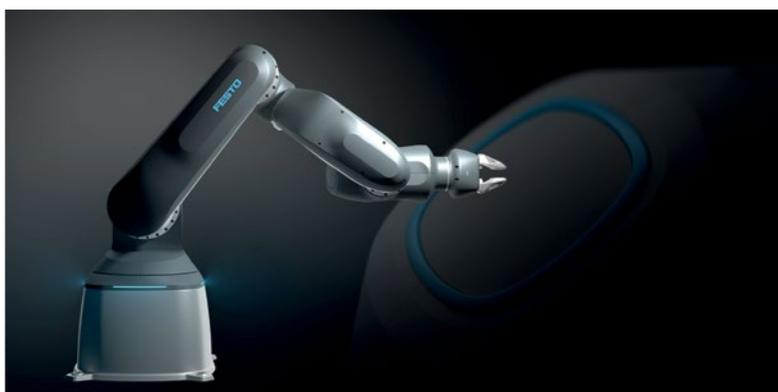
Der Festo-Cobot ist leicht zu bedienen, kommt ohne Schutzzaun aus und wird laut seinem Hersteller auch preislich attraktiv sein.
