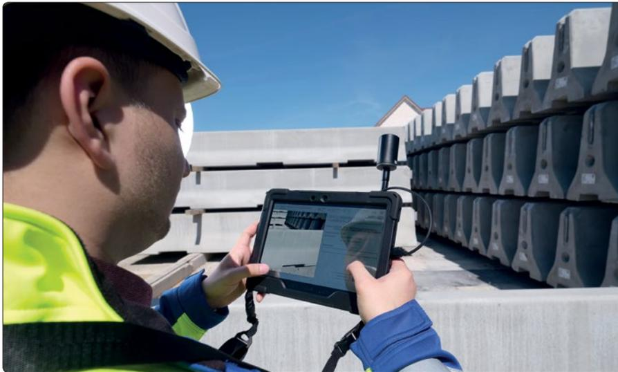
Die kartographische Verortung der Betonfertigteile erfolgt mit Hilfe von GPS mit einer maximal möglichen Genauigkeit im Sub-Dezimeterbereich.
