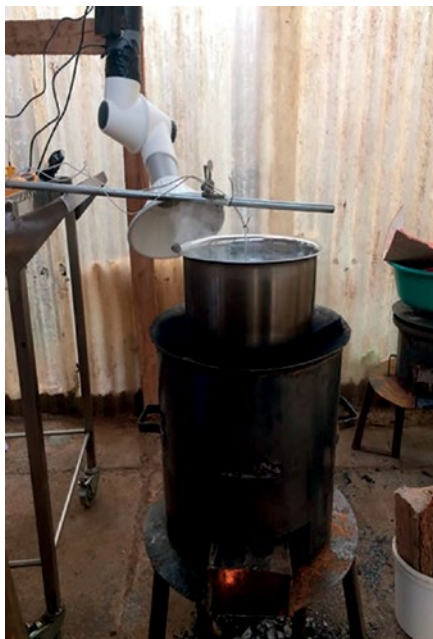
Kochofen für gleichzeitige Biokohleherstellung (links); Wassersiedetest zur Bestimmung der Energieeffizienz (rechts).
