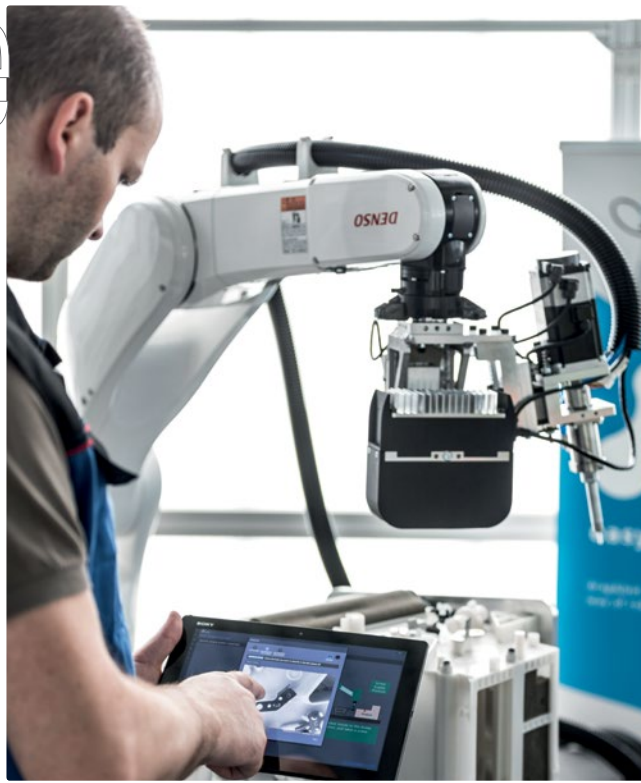
»drag and bot«: Eine intuitive Benutzeroberfläche ermöglicht ohne aufwändige Schulung eigenständig Roboteranwendungen umzusetzen.
