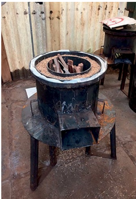
Kochofen für gleichzeitige Biokohleherstellung (links); Wassersiedetest zur Bestimmung der Energieeffizienz (rechts).
