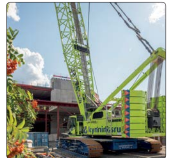
Die grüne Alternative von Liebherr: der erste batteriebetriebene Raupenkrane.
