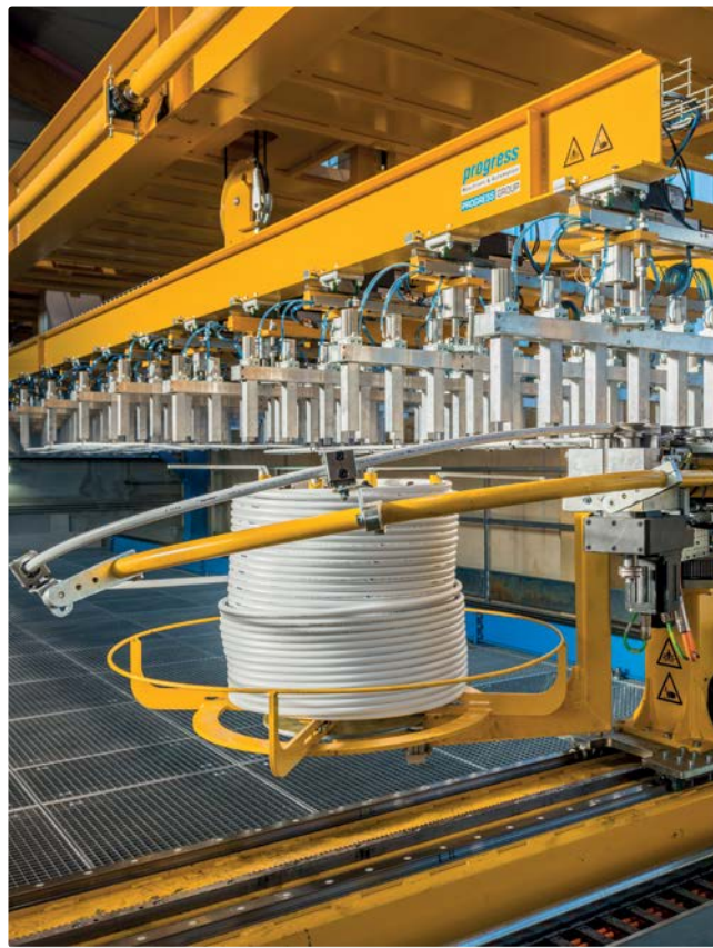
Der Rohrverlegeroboter biegt die Rohre vollautomatisch nach den Daten aus dem Elementplan.
