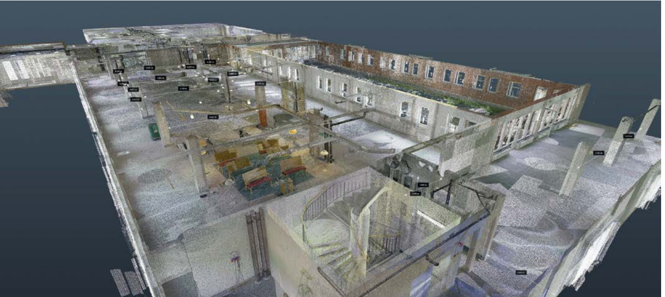
Die Bausoftware White ReCapture von White Arkitekter analysiert Gebäude im Bestand mittels 3D-Laserscanning, um wiederverwertbare Materialien für die Neuproduktion sowie bei Retrofit- oder Erweiterungsprojekten zu identifizieren und ist damit eine Lösung für mehr Kreislaufwirtschaft in der Architektur.
