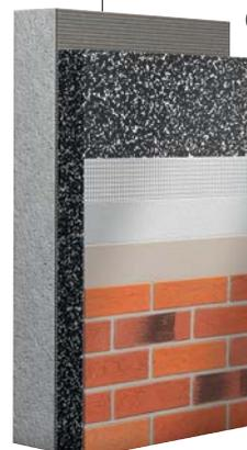
Beispiel Fassadenaufbau auf EPS-WDVS mit Melderfer Flachverblender.
