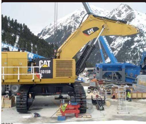
Die umfangreiche Komplettierung des 140 Tonnen Großhydraulikbaggers wird direkt vor Ort durchgeführt.
