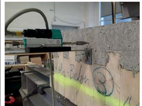
Messung der Schubverformung zwischen Holz und Beton am Deckenelement von Longin.
