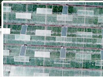
LGV-Frischgemüse ist auf die Glashausproduktion spezialisiert. Die PV-Paneele werden direkt am Glashausdach angebracht.
