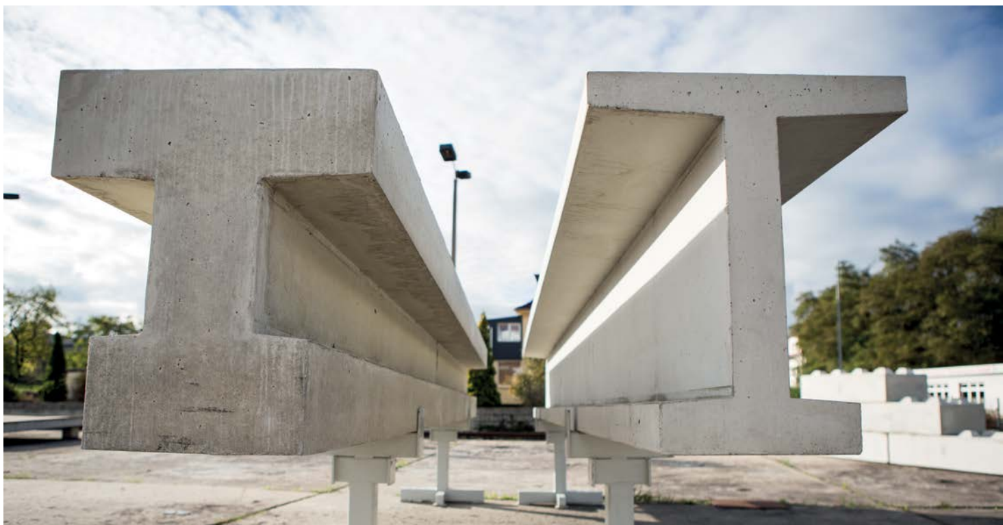
Carbonbeton soll als Alternative für Stahlbeton eine neue Art des Bauens begründen. (Doppel-T-Träger)
