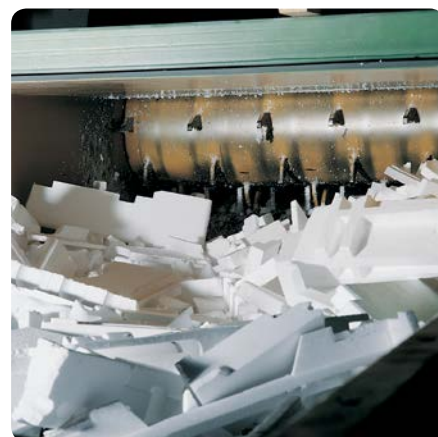
Beim mechanischen Recycling werden die Styropor-Abfälle zu Granulat vermahlen, können Wärmedämmplatten zugesetzt und als Zuschlagstoff für Leichtbeton, mineralisch gebundene Ausgleichsschüttungen und Dämmputze eingesetzt werden.
