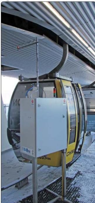
Speziell für Seilbahnbetriebe hat ÖWD security systems ein neues Gerät entwickelt, das Kabinen mittels Trockennebel in nur zwei Sekunden komplett von Viren und Keimen befreit.
