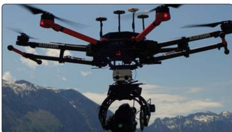
Erfassen die Sensoren ein Hindernis, werden Ausweichmanöver bis hin zur Landung eingeleitet.
