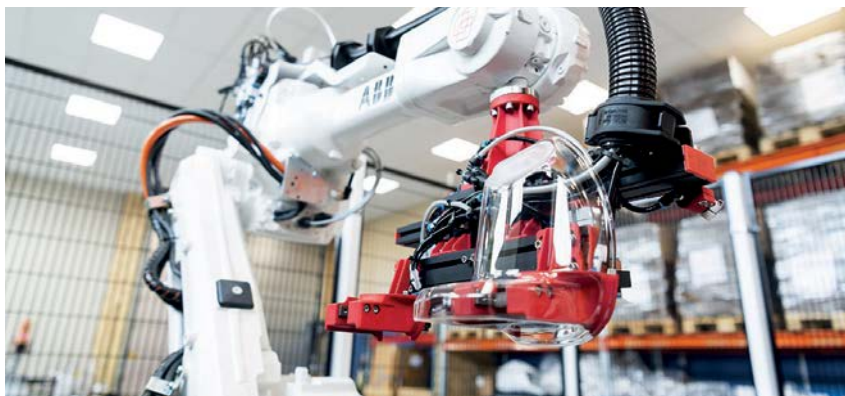
Ein Sechachsroboter übernimmt bei Tiki Safety das Handling von Atemschutzmasken.
