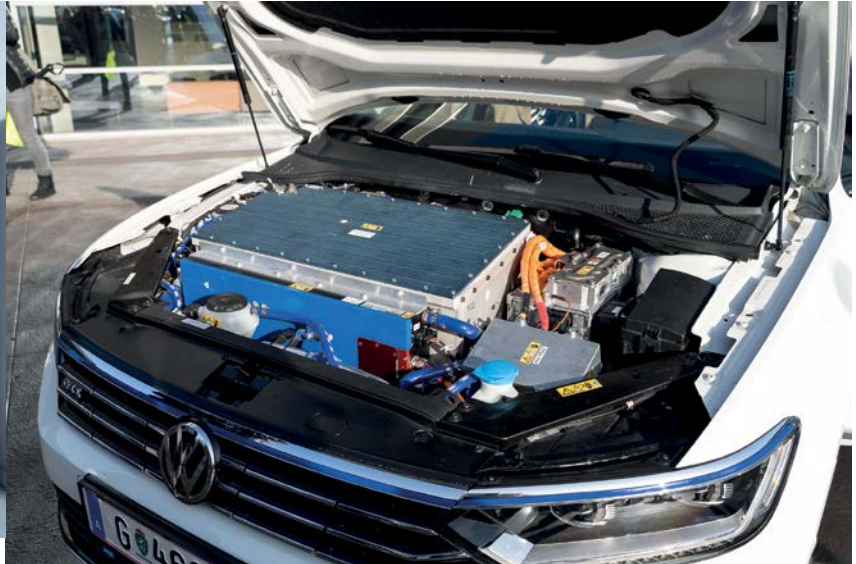
Beim Projekt Keytech4EV wurde durch die Kombination der Brennstoffzelle mit einer bewusst größeren Batterie ein wichtiger Schritt in Richtung hohe Effizienz und gute Kostenbalance erzielt.
