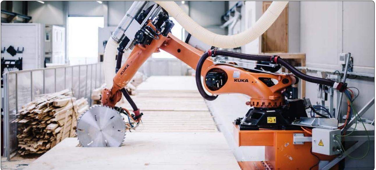
Theoretisch kann die Roboteranlage von Leidorf fast alle Materialien bearbeiten, optimiert ist sie für Brettsperrholz.
