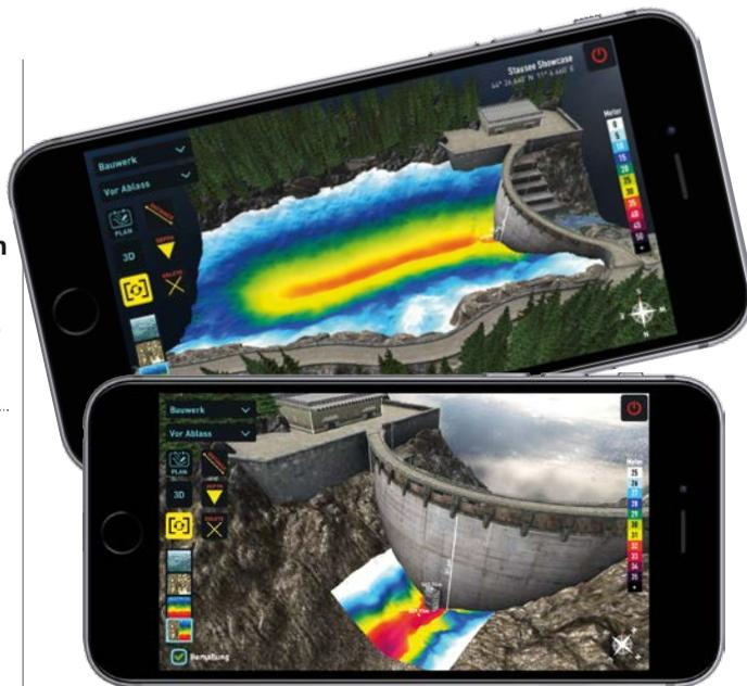
Das Team von Ocean Maps digitalisiert und visualisiert mit Sonartechnik unter Wasser sowie Drohnen und Photogrammetrie auch Binnengewässer und Speicherkraftwerke.
