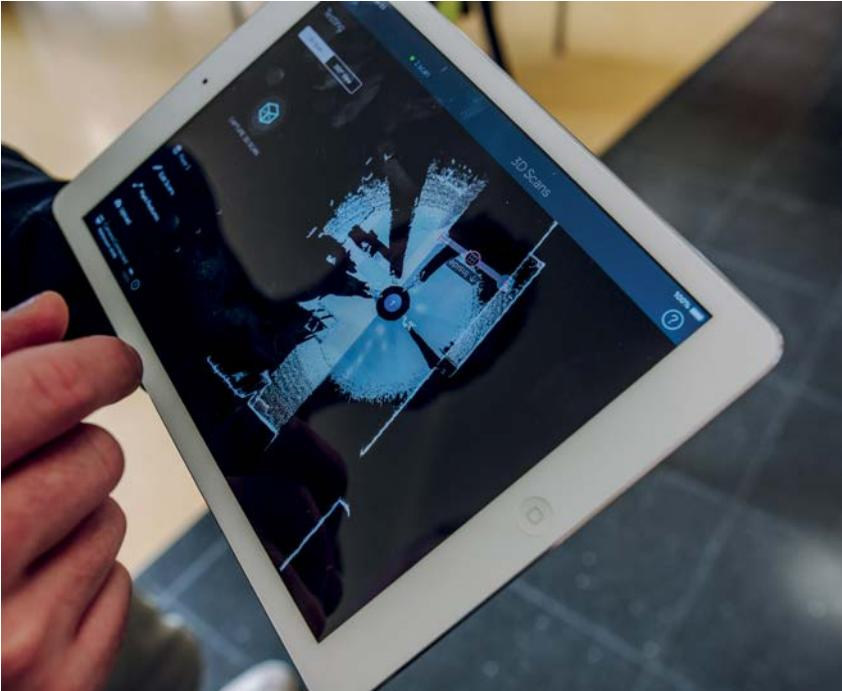
Per Laserscan und 360-Grad-Kameras wird das Gebäude Raum für Raum digitalisiert.
