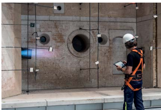
Das IBS betreibt in Linz einen der höchsten Vertikalprüföfen in Europa. Er bietet Prüfmöglichkeiten für Bauteilkonstruktionen bis zu neun Meter.
