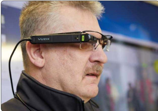
Digitaler Abnahmeprozess mit Assisted Reality und vernetzter Brille in der Werkstatt von ÖBB Postbus.
