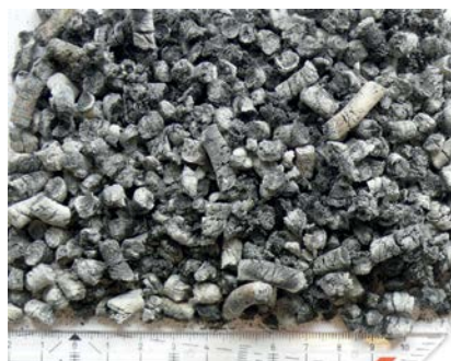
Das Abbrand-Verhalten biogener Brennstoffe wie Stroh lässt sich durch Zugabe von geeigneten Additiven deutlich verbessern, etwa durch die Zugabe von 4 Prozent Kaolin.
