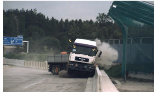
Mit »Zero Debris Concrete« hat Kirchdorfer einen abplatzungsfreien Beton für Betonleitsysteme entwickelt.
