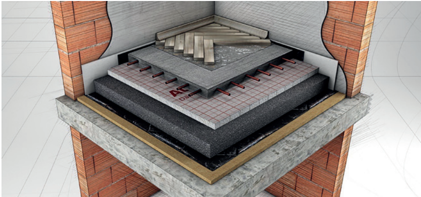
Mit der Trittschallrolle (Bild) und der Kombi Perimeterdämmung/Drainage XPS TOP Drain bietet Austrotherm zwei neue Dämmprodukte.
