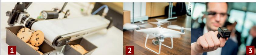
■ **EINE KAMERA**, die auf dem Förderband montiert ist, erfasst das Bild der Cookies. Das Bild wird dann von der KI-Engine verarbeitet und mit verschiedenen Parametern – Farbe, Form, Zahl der Schokoladestücke – verglichen, um den Zustand des Cookies zu bestimmen. Metalldetektions-Sensoren am Förderband können einen Alarm auslösen und Benutzer auf seinem Wearable benachrichtigen (1).
