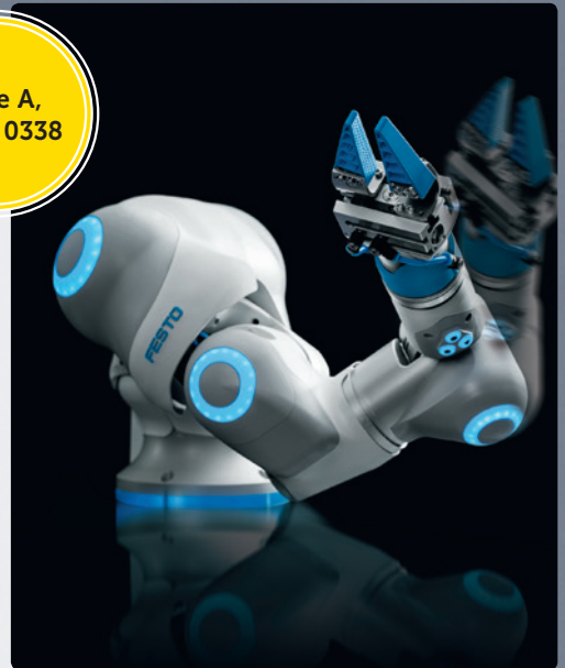
Der BionicCobot von Festo ist ein pneumatischer Leichtbauroboter mit menschlicher Bewegungsdynamik.
