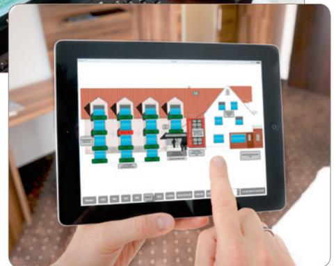
Mit der Visualisierungs-Software kann die automatische Gerätesteuerung schnell und bequem per Tablet erfolgen.
