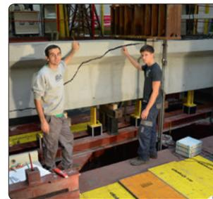
Bei ihrem Experiment belasteten Patrick Huber und Tobias Huber Spannbetonträger mit einer Länge von 14 m und 75 cm Höhe gezielt mit hydraulischen Pressen, bis die Versuchsträger versagten.
