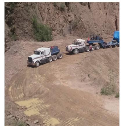
Schwerlastlogistik unter schwierigsten Bedingungen: Die größten Transporte haben ein Gesamtgewicht von 227 Tonnen bei 37 Metern Länge, fünf Metern Breite und fünf Metern Höhe.
