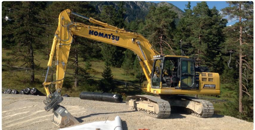
Beim Bau eines Speicherteiches in Hoch-Imst setzt die Firma Fiegl Tiefbau einen semi-automatischen GPS-gesteuerten Hydraulikbagger von Komatsu ein, der Vermessungen und Absteckarbeiten überflüssig macht.
