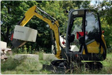
Der autonome Bagger kann beispielsweise Gefahrstoffe bergen oder kontaminierte Bodenschichten abtragen.
