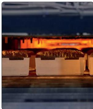
Foamglas besteht aus geschäumtem Glas. Im Produktionsprozess wird es mit Kohlenstoff versetzt und erhält dadurch seine Zellstruktur.
