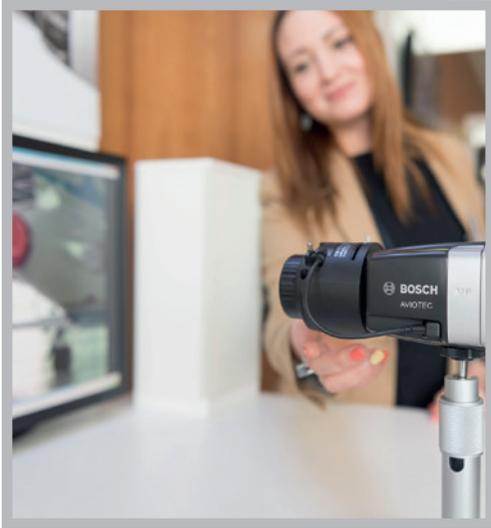
**Mit Aviotec von Bosch** werden Brände innerhalb von Sekunden direkt am Brandherd erkannt. Betriebsbedingte Störgrößen wie Bewegungen durch Personen oder sich verändernde Lichtverhältnisse können technisch ausgeblendet werden.
