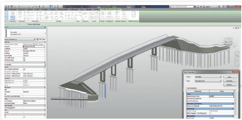
BIM umfasst alle Geometrien eines Projektes. Die Mayrederbrücke ist eine Geh- und Radwegbrücke zur Querung der vorhandenen und künftigen Verkehrswege im Bereich der bestehenden U2-Station Aspern.
