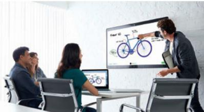
In einer neuen Version werden alle Inhalte nun automatisch gespeichert. Weiters gibt es mit dem »Cisco Spark Board« ein cloudbasiertes Whiteboard mit 55- oder 70-Zoll-Bildschirmdiagonale, HD-Kameras, intelligent gesteuerten Mikrofonen und Lautsprechern.
