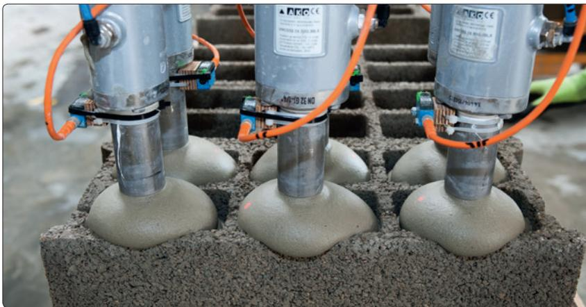
Der mineralische Dämmschaum wird in Leichtbetonsteine verfüllt.
