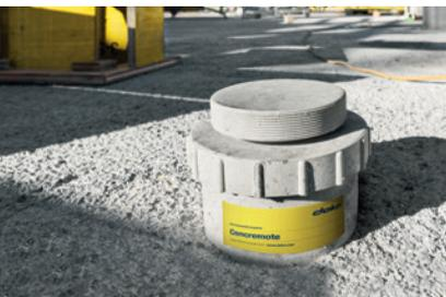
Doka Concremote: Mittels Sensoren wird der optimale Ausschallungszeitpunkt erfasst und digital übermittelt.
