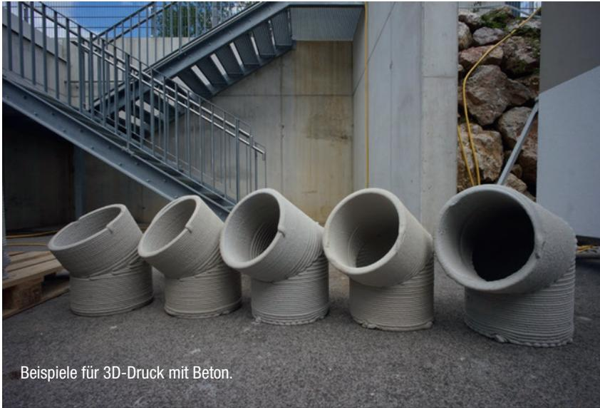
Beispiele für 3D-Druck mit Beton.
