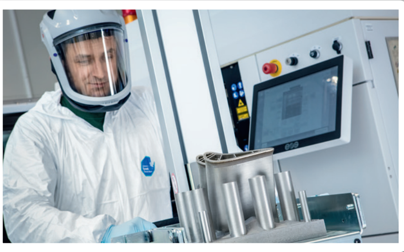
Mittels Lasern von Metallstaub werden im »Additive Manufacturing« neuartige Formen wie etwa wabenartige Strukturen von Komponenten für die Industrie möglich.
