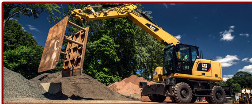
Im Baustelleneinsatz werden bei den neuen Cat-Mobilbaggern der Serie F Achspendelung und Feststellbremse automatisch blockiert.
