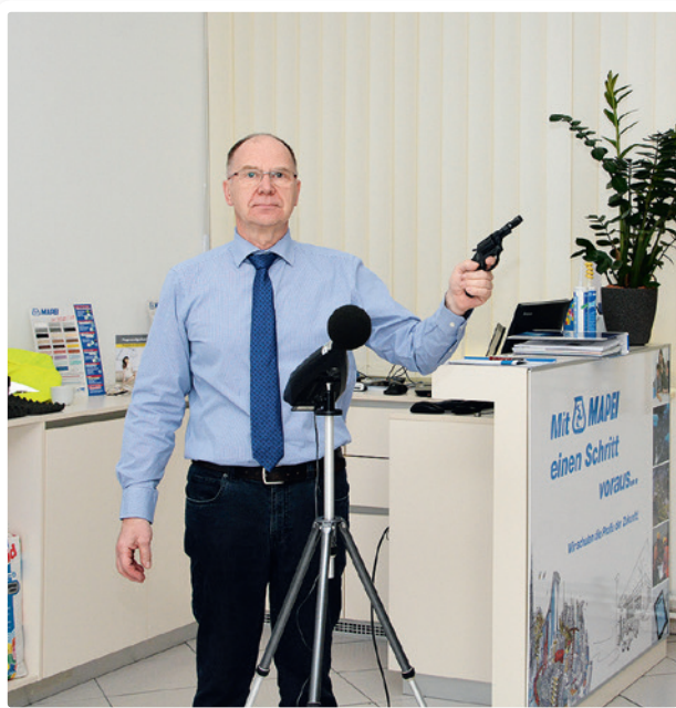
Mithilfe einer Schreckschusspistole wurden Messungen zum Schallschutz durchgeführt.
