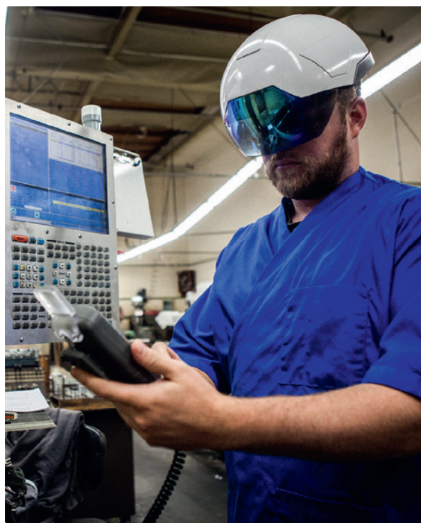
Actemium bietet Teststellungen für Pilotprojekte mit dem intelligenten Sicherheitshelm mit integrierter Datenbrille zum mobilen Bedienen des Maschinenparks.
