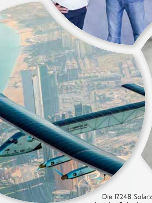
Die 17.248 Solarzellen der Solar Impulse 2 ergeben eine Fläche von 270 m<sup>2</sup> und sind so dünn wie ein menschliches Haar: lediglich 135 Mikrometer.
