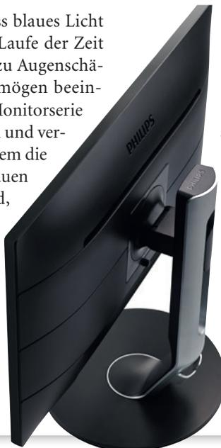
Serie ein Sensor integriert, der durch das Aussenden und Empfangen von Infrarotsignalen erkennt, ob sich der Benutzer in der Nähe des Geräts aufhält. Der Monitor reduziert automatisch die Bildschirmhelligkeit, wenn sich der Benutzer vom Schreibtisch entfernt. Der Energieverbrauch kann damit um bis zu 80 % gesenkt werden. ■
