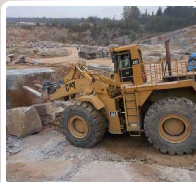
Im Granitwerk Kammerer bewegt ein Cat 992C bis zu 60 Tonnen schwere Granitblöcke.
