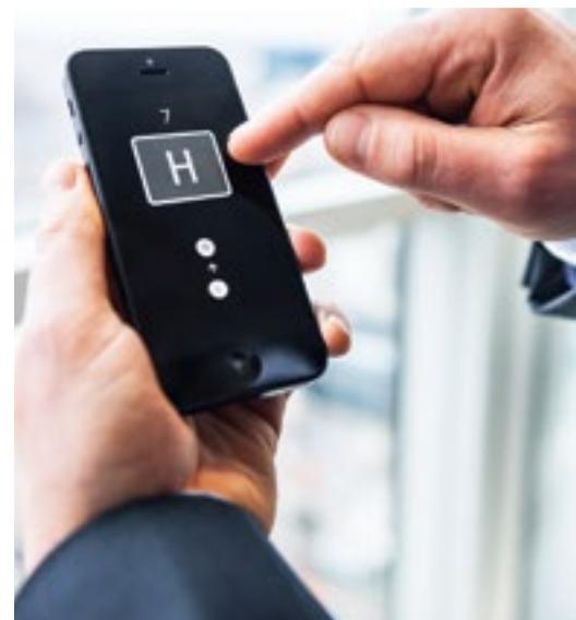
Mit dem Kone RemoteCall können mittels App personalisierte Aufzugsrufe abgesetzt werden.
