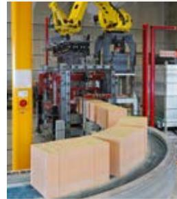
Eine neue, 2,5 Millionen Euro teure Anlage verfüllt im Wienerberger-Werk in Haiding vollautomatisch mineralische Steinwolle in Ziegel.
