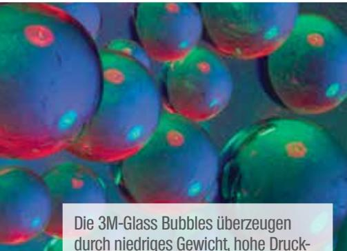
Die 3M-Glass Bubbles überzeugen durch niedriges Gewicht, hohe Druckfestigkeit, fehlende Porösität, reduzierte Wärmeleitfähigkeit und erhöhtes Isolierpotenzial. Damit sind sie u.a. geeignet als Leichtbaumaterial für den Automobilbereich sowie als Zuschlagstoff für Beton.
