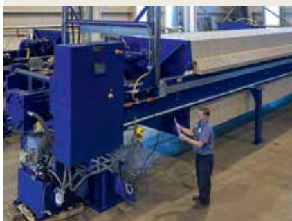
Seitenholm-Filterpressen werden in Abwasseraufbereitungsanlagen zur Schlammwässerung eingesetzt.
